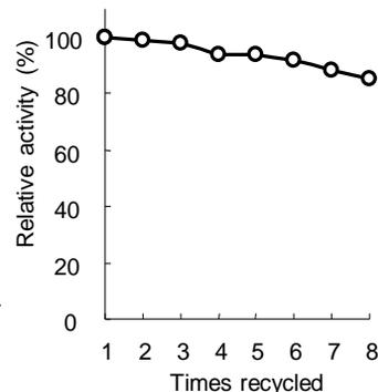
气孔径6.0nm的介孔材料承载了脂肪酶前(○)后(●)的细孔分布(右)和反复使用时的活性变化。
