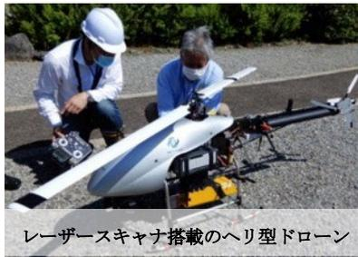
レーザースキャナ搭載のヘリ型ドローン
