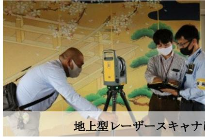
地上型レーザースキャナによる計測（屋内・屋外）
