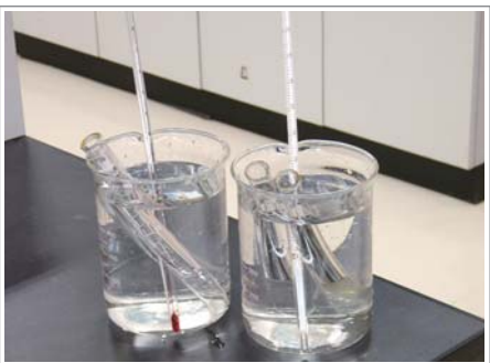
写真4：水温調整をしたビーカーに 溶液a、bが入った試験管を入れる
