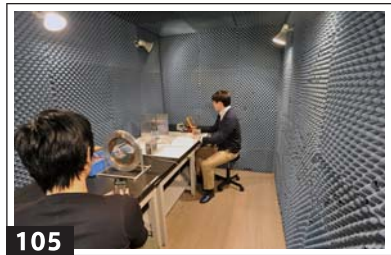
電磁波の実験において不必要な電波干渉を除く電波シールド室。
