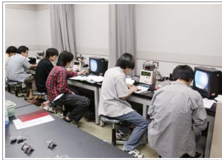
写真2：電場中の帯電した粒子の運動を観測 (電気素量の直接測定)
