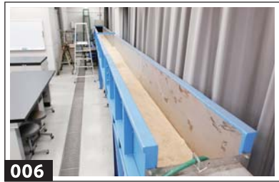
水流による砂の流れ方や堆積の仕方から地層を調べる循環式実験水路
