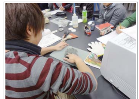
写真9：ただの泥遊びではありません。粘土の粘性を調べる実験です。粘土の物理的性質は、地震時の液状化現象などの地盤災害と結びつく重要な性質です。
