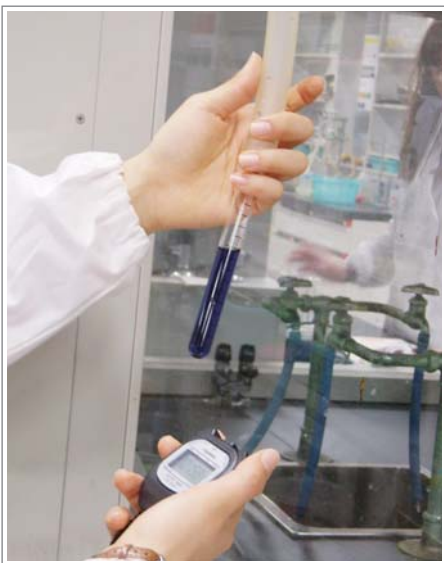
写真3：色がつき始めた瞬間に ストップウォッチを押す
